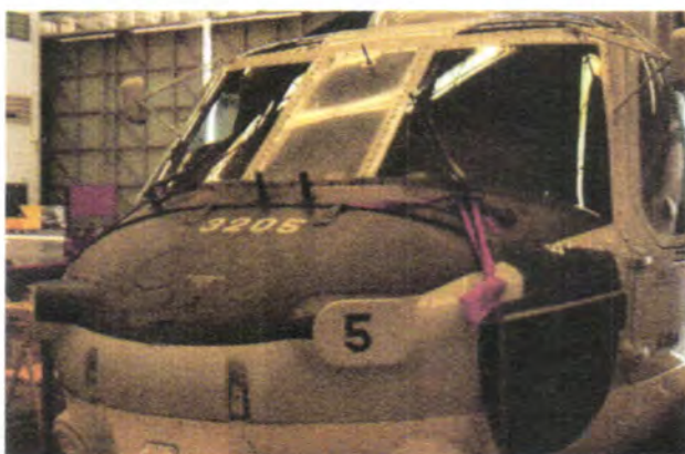
ภาพที่ ๒๒ การปิดคลุมด้วยแผ่นปิด (Covers) หรือหมอนอุด (Dust Plug) เพื่อป้องกันฝุ่น
