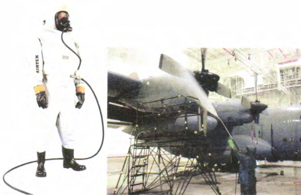
ภาพที่ ๑๗ การสวมใส่ชุดป้องกัน เมื่อใช้สารเคมีทำความสะอาดอากาศยาน
